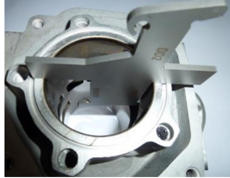
5.5.7 Egzoz portu zamanlaması (Silindir ID Tanımlama Kodu 413530, 413531, 613934)
